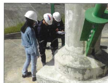
รูปที่ 11 แสดงการทดสอบค่าความต้านทานรากสายดิน
